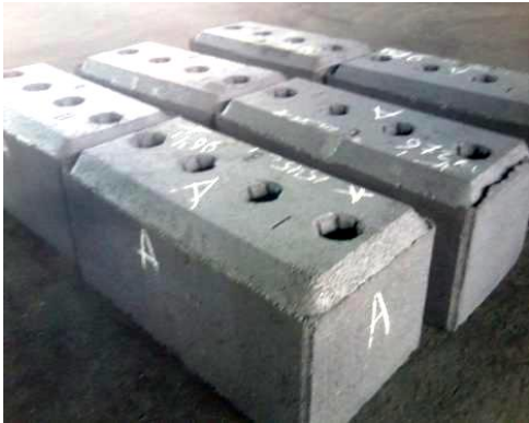
Рисунок 4.7 - Экспериментальные «зеленые» анодные блоки
