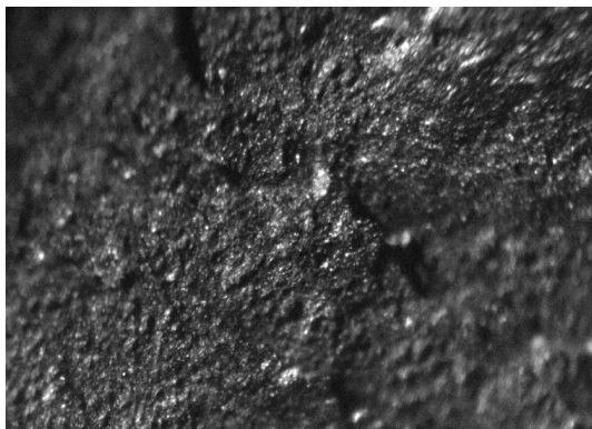
с. Микроструктура антрацита термообработанного при 1400^{\circ}\text{C} , \times 450
