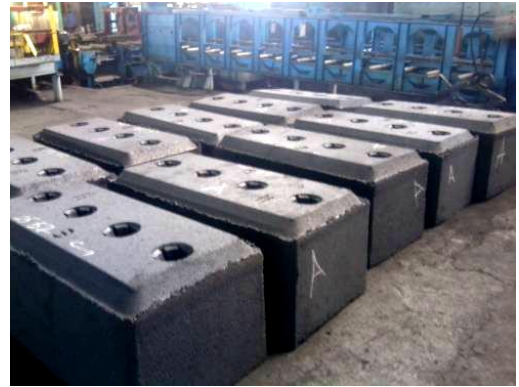
Рисунок 4.7 - Экспериментальные «зеленые» анодные блоки
